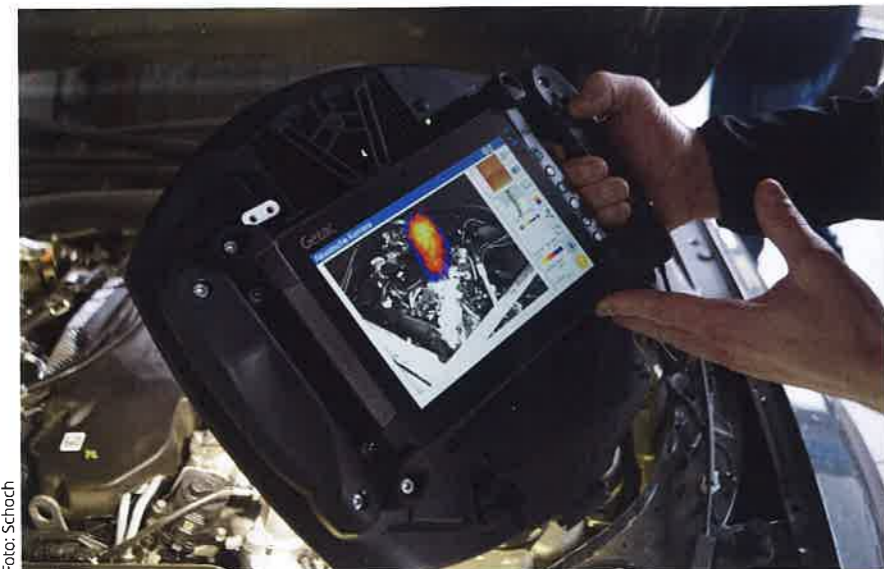
Die ACAM ist klein und leicht genug, um sie mobil zum Detektieren von Fahrt- und Störgeräuschen im Fahrzeug einzusetzen.
