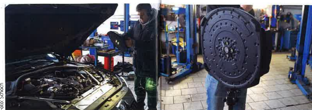
Mit Kopfhörer kann der Anwender am Bildschirm die Geräuschquelle genau lokalisieren.
