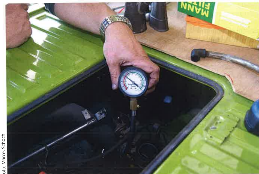
Für eine schnelle Messung der Kompression im Motor halten viele Kfz-Betriebe auch noch die klassische Kompressionsuhr vor.
