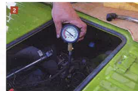
1: Der Kompressionschreiber wird auf das Zündkerzengewinde des Zylinders (Pfeil) gedrückt, während ein zweiter Mann den Motor bei geöffnetem Vergaser startet. 2: Alternative Kompressionsmessung: Hier zeigt eine Uhr mit Schleppzeiger den Kompressionsdruck an. 3: Der Öleinfüllstutzen (Pfeil) ist sauber, keinerlei Versulzung sichtbar. Auch den Deckel in Augenschein nehmen!
