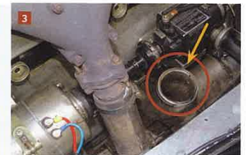
1: Der Kompressionschreiber wird auf das Zündkerzengewinde des Zylinders (Pfeil) gedrückt, während ein zweiter Mann den Motor bei geöffnetem Vergaser startet. 2: Alternative Kompressionsmessung: Hier zeigt eine Uhr mit Schleppzeiger den Kompressionsdruck an. 3: Der Öleinfüllstutzen (Pfeil) ist sauber, keinerlei Versulzung sichtbar. Auch den Deckel in Augenschein nehmen!
