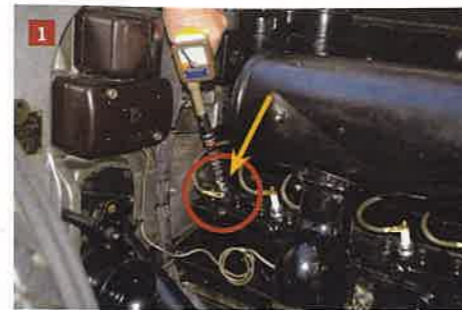
1: Der Kompressionschreiber wird auf das Zündkerzengewinde des Zylinders (Pfeil) gedrückt, während ein zweiter Mann den Motor bei geöffnetem Vergaser startet. 2: Alternative Kompressionsmessung: Hier zeigt eine Uhr mit Schleppzeiger den Kompressionsdruck an. 3: Der Öleinfüllstutzen (Pfeil) ist sauber, keinerlei Versulzung sichtbar. Auch den Deckel in Augenschein nehmen!
